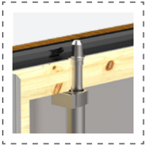
Vertikale Einbruchschutz- -Verriegelung*
