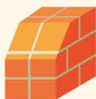
соответствуют стене толщиной 550 мм
